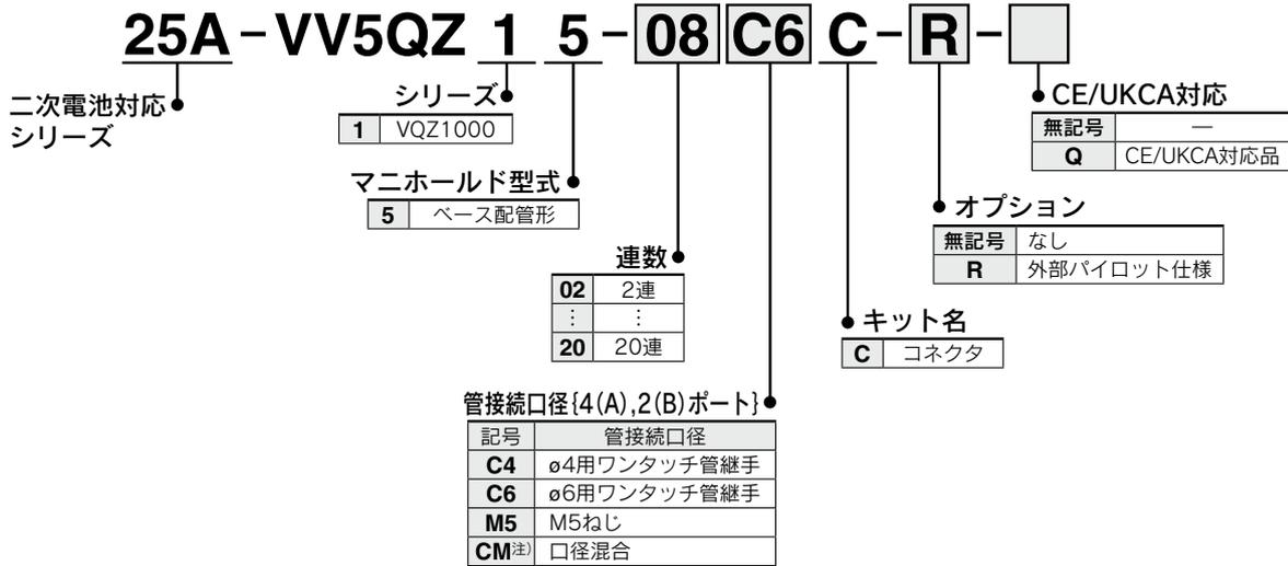
注) 口径混合およびポートプラグ付の場合はマニホールド仕様書にてご指示ください。また、口径混合、ポートプラグはワンタッチ管継手タイプのみ可能です。
