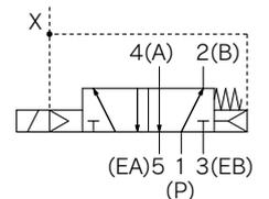
注) 外部パイロットタイプの場合、外部パイロット(X)ポートを排気し、同時にメイン圧力も排気してください。
