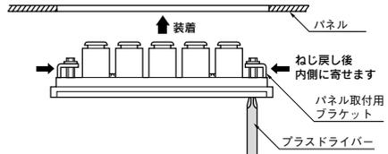
3)プラスドライバにて、ブラケット用ボルトを外側に寄せてから締め込み、ソケットケースを固定します。
