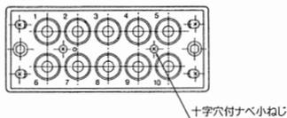
②任意の位置のコネクタを交換後、再びブラスタライバにてプレートをケースに取付けます。
