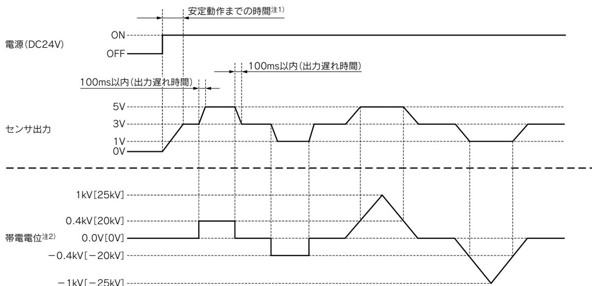
注1) 電源投入後約1秒でセンサは動作可能状態となりますが、不安定な値を示す場合がありますので、電源投入後10分以上経過してから使用することを推奨します。
