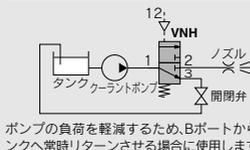
ポンプの負荷を軽減するため、Bポートからタンクへ常時リターンさせる場合に使用します。
